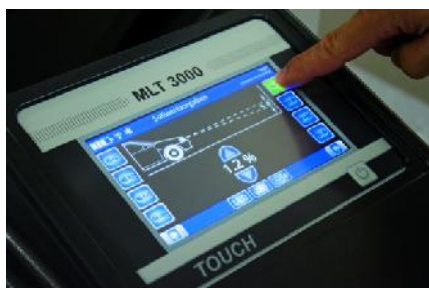
7"-Touch-Bildschirm mit selbsterklärenden Tasten zur einfachen Bedienung des Gerätes.
